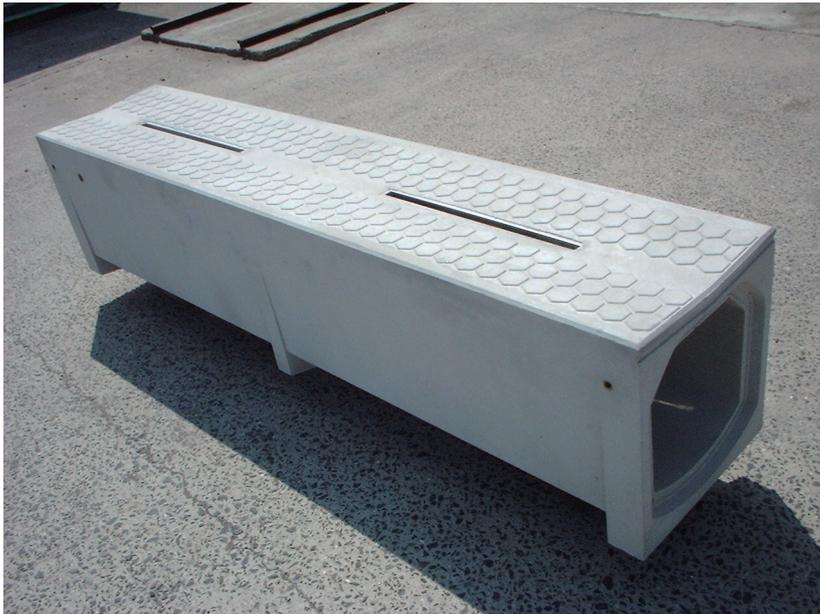
スリム側溝は、箱型構造により車両通行時のガタガタ音が発生しない構造で、表面甲羅模様と縦長スリットにより集水性能に優れ水たまりの発生が抑制されます。
