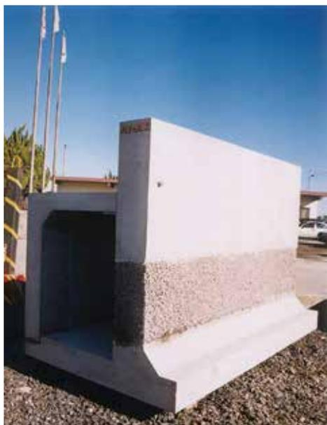
デバンは、堤防補強・堤防強化工事で主に用いられる堤脚水路製品です。堤体内浸透水を効率よく堤脚水路に集水し排水でき、かつ土留めと堤脚水路を一体化したプレキャスト製品にすることで堤防側路スペースを拡幅できる技術です。
